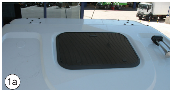
Kabina Stralis sprzed roku 2008: Uszczelka EPDM 40 x 40
